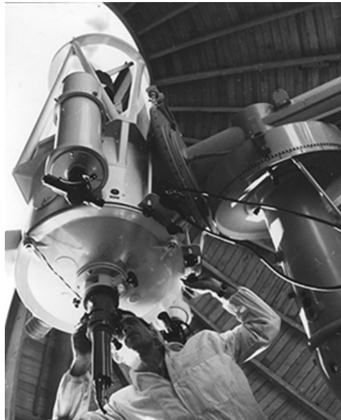
Fig. 4 – Telescopul Cassegrain de 50 cm dotat cu fotometru fotoelectric.
